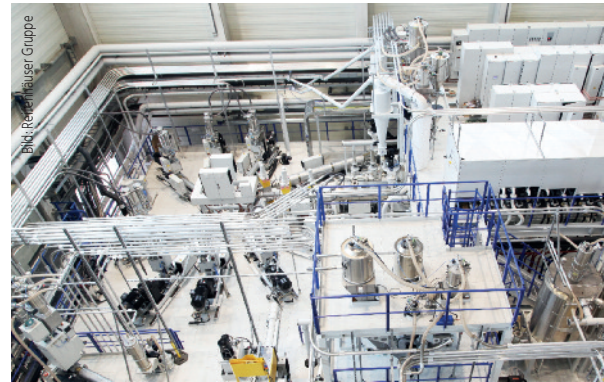
Die Komplexität einer Kunststoffextrusionsanlage merkt man den fertigen Erzeugnissen oft nicht an. Alleine ein Gefrierbeutel besteht aus fünf dünnen Kunststoffschichten.
