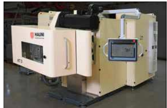
Der Tabakschneider ist als klassisches Maschinenbauprodukt ein Bestandteil der Gesamtanlage.
