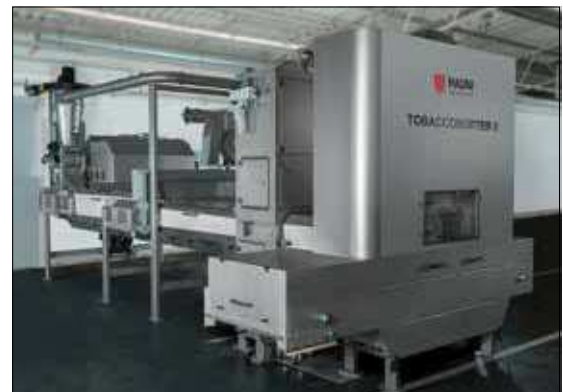
Bis zu 10 Tonnen Tabak pro Stunde befreit der Tobaccosortierer 8 mittels High-Tech-Kameras von Fremdkörpern.
