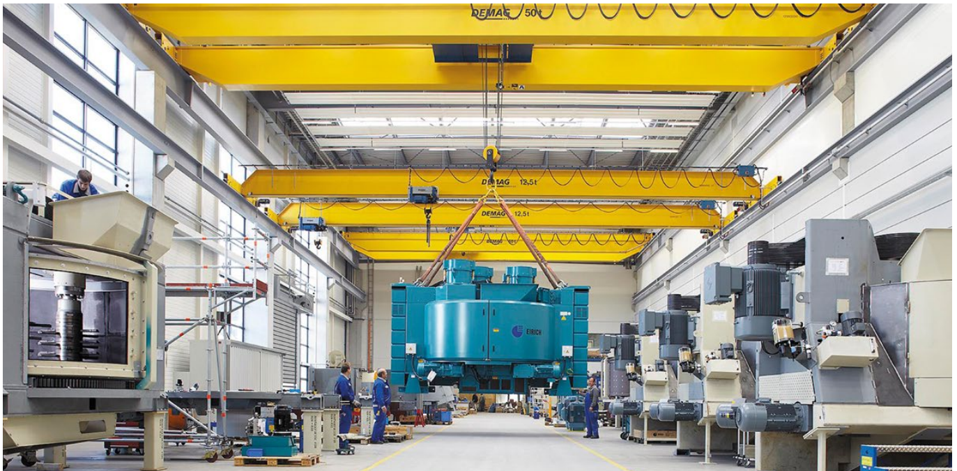
Montagehalle in Hardheim mit Großmischer Typ DW40
